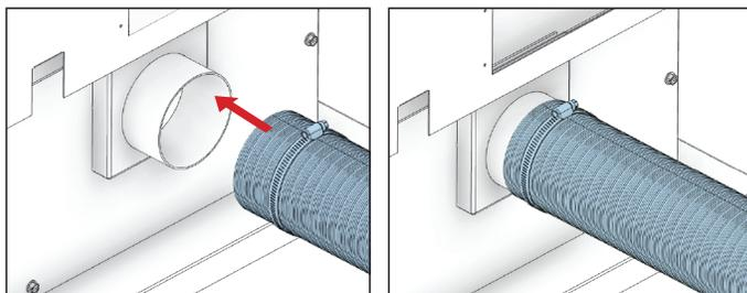
Faites glisser le collier de serrage sur le tuyau flexible en aluminium. Ensuite, glissez le tuyau flexible sur le tube d'admission d'air du poêle. Serrez ensuite le collier de serrage sur l'extrémité du tuyau flexible en aluminium.
