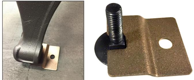
En plus des exigences d'installation précédemment détaillées, le radiateur doit être mis à la terre électriquement au châssis en acier de la maisons mobiles/bâtiments portatif avec un fil de cuivre 8 GA à l'aide d'une rondelle dentelée ou en étoile pour pénétrer la peinture ou le revêtement de protection pour assurer la mise à la terre.
