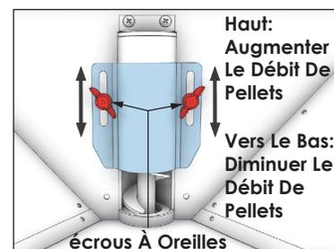
Il est courant dans l'industrie des granulés que la taille moyenne des granulés varie. En raison des différentes tailles de granulés, cet appareil est équipé d'un régulateur de carburant pour ajuster la quantité de carburant autorisée à passer dans l'ensemble de la vis sans fin. Le régleur de carburant est situé à l'intérieur de la trémie. Remarque: le paramètre d'usine par défaut pour cela est complètement ouvert. Pour diminuer le débit de granulés, abaissez le régleur de carburant.
