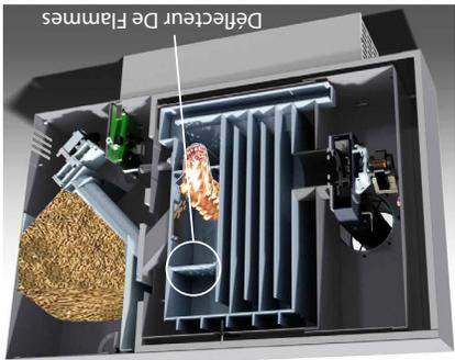
S'assurer que le déflecteur de flammes est correctement installé. Si le déflecteur n'est pas bien installé, poussez la plaque vers le haut dans le vide en l'inclinant, faites-la pivoter à l'horizontale et placez-le sur les butées métalliques
