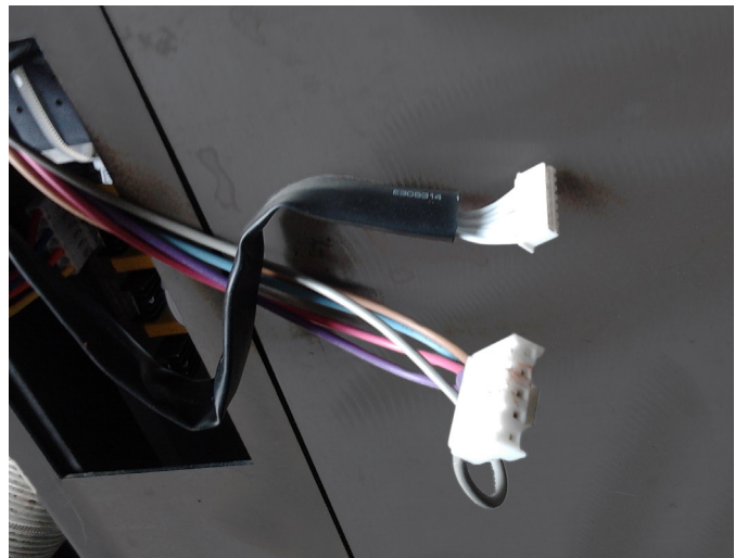
1. Tirez les fils installés en usine hors du haut du poêle. Il y aura deux faisceaux de câbles, comme illustré.
