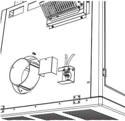
Souhaitez votre souffleur serait allumer et éteindre le chauffe devient chaud et le froid? Il peut avec ce kit optionnel de Stove États-Unis. Il se connecte en ligne avec votre cordon d'alimentation et monte à l'arrière de l'appareil. Lorsque le disque de pression atteint 120 degrés, le ventilateur se met automatiquement en marche et se met hors tension si elle atteint 90 degrés. Consultez votre concessionnaire pour les détails ou appeler directement Poêle États-Unis.
