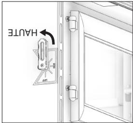
Après la première charge de combustion élevée et le poêle est bien réchauffé, ajustez l'unité au besoin pour un réglage de combustion moyen ou faible.
