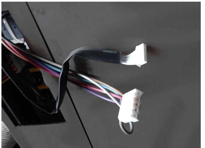
3. Connecter les installés en usine faisceaux de câblage sur le panneau de commande comme indiqué.
