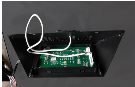
Étape 2 Déballer les meilleurs contrôles de montage et de veiller à ce que le faisceau de câblage illustré est fixé.
