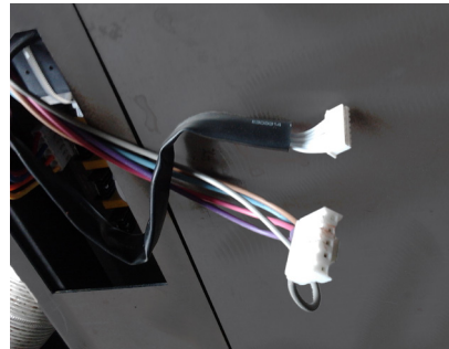
Étape 1 Tirer les fils installés en usine sur le dessus du poêle. Il y aura deux faisceaux de câbles, comme illustré.
