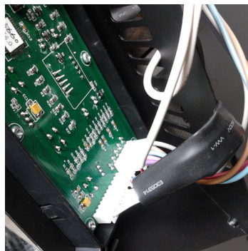
Étape 3 Connecter les installés en usine faisceaux de câblage sur le panneau de commande comme indiqué.
