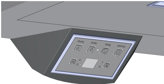
Étape 4 Fixer le panneau de commande au dessus du poêle, comme indiqué. Étape 5 Fixer avec deux vis à tôle.
