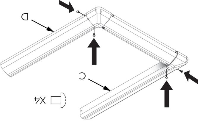
3. Glissez l'ensemble de plinthe en U autour de la base du socle et fixez-le avec deux vis à tête cylindrique large de 1/4 po aux coins arrière.
