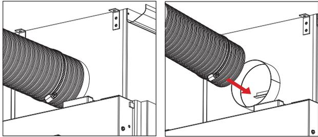
Faites glisser le collier de serrage sur le tuyau flexible en aluminium. Ensuite, glissez le tuyau flexible sur le tube d'admission d'air du poêle. Serrez ensuite le collier de serrage sur l'extrémité du tuyau flexible en aluminium.
